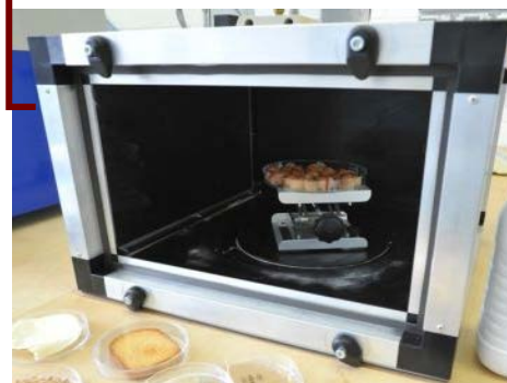
Εικόνα 8. Θάλαμος επεξεργασίας με πλάσμα.
