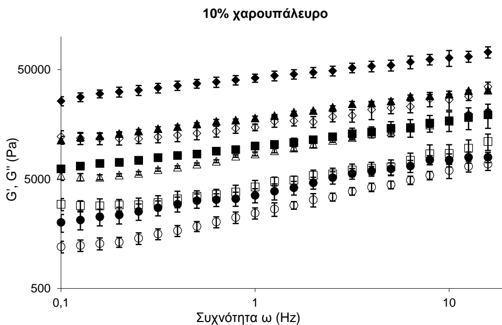
Σχήμα 5.3.2 Επίδραση της περιεκτικότητας σε νερό σε ζυμάρια με 10% χαρουπάλευρο στον συντελεστή αποθήκευσης ( G' ) και στον συντελεστή απωλειών ( G'' ). Οι τιμές είναι οι μέσοι όροι τριών επαναλήψεων και οι ράβδοι σφάλματος αντιπροσωπεύουν την τυπική απόκλιση. Κλειστά σύμβολα, G' ; ανοικτά σύμβολα, G'' . \blacklozenge 80% περιεκτικότητα σε νερό, \blacktriangle 90% περιεκτικότητα σε νερό, \blacksquare 100% περιεκτικότητα σε νερό, \bullet 110% περιεκτικότητα σε νερό.
