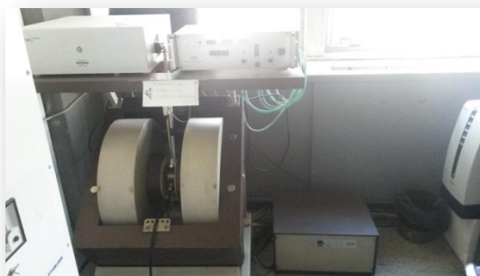
Εικόνα 3.5: Φασματοφωτόμετρο ηλεκτρονικού παραμαγνητικού συντονισμού (EPR). Φαίνεται η κονσόλα ελέγχου των ηλεκτρονικών και επεξεργασίας του σήματος, η πηγή των μικροκυμάτων και ο
