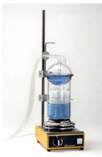
Εικόνα 7: Συσκευή προσδιορισμού κυτταρίνης-λιγνίνης.
