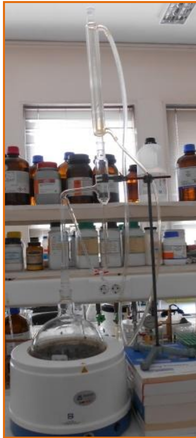
Εικόνα 16. Αποστακτικό συγκρότημα (Πηγή: Τράκα Χρυσοβαλάντη)
