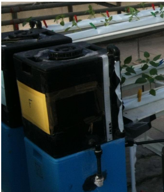
Εικόνα 2.1: Δεξαμενή συμπλήρωσης (μαύρη) και ανακυκλούμενου (μπλε) θρεπτικού διαλύματος καθώς και η σύνδεση των δοχείων όπου παρεμβάλλεται ο πλωτήρας.
