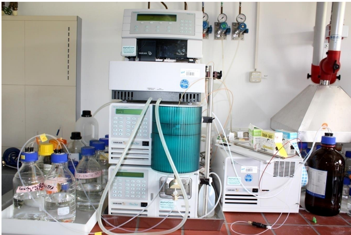
Εικόνα 0.14: Το σύστημα HPLC της Varian (ProStar 215) που χρησιμοποιήθηκε για την ανίχνευση των δραστικών ουσιών.
