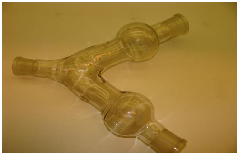
Εικόνα 2.3.1. Διπλής επιλογής σχήματος Y- ολφακτόμετρο
