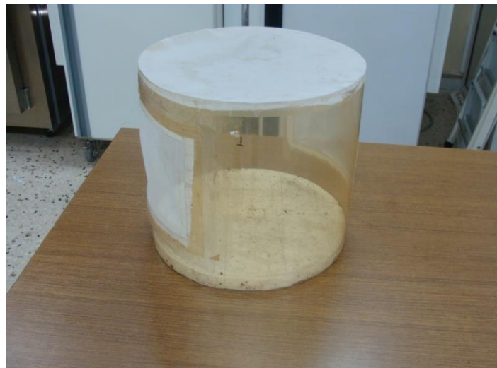
Εικόνα 1.3.13. Κλωβός για τη διεξαγωγή των μετρήσεων του πειράματος
