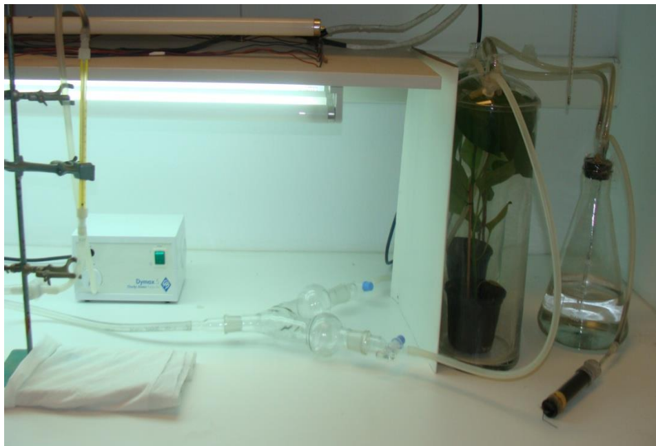
Εικόνα 2.3.6. Διάταξη Y-tube olfactometer
