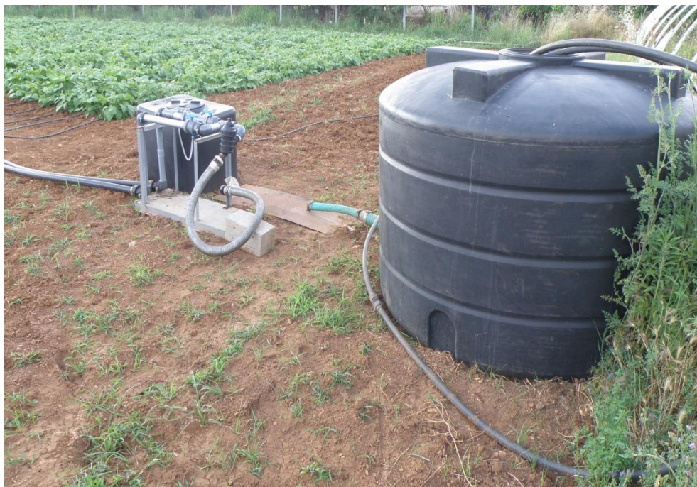
Εικόνες 2 & 3: Αρδευτικό σύστημα τύπου στάγδην που εγκαταστάθηκε στον πειραματικό αγρό καλλιέργειας φασολιού (Άνοιξη-Καλοκαίρι 2011).
