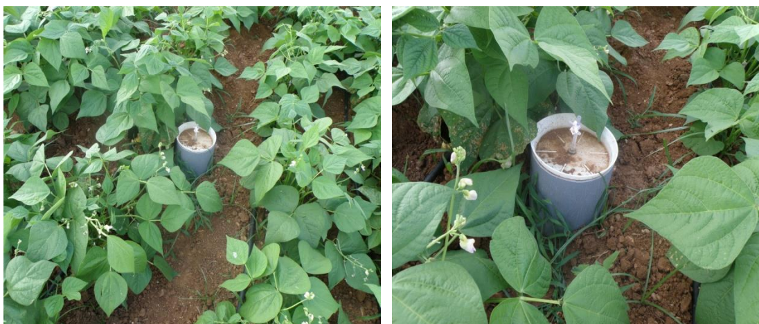
Εικόνα 8 & 9: Δειγματολήπτης αερίων θερμοκηπίου ( N_2O , CO_2 , CH_4 ) που χρησιμοποιήθηκε κατά την διάρκεια των πειραμάτων αγρού σε καλλιέργεια καθιστού φασολιού.
