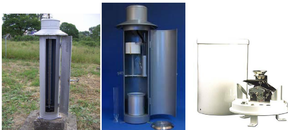
Εικόνα 2.3 α) Δεκαπλασιαστικό βροχόμετρο β)βροχογράφος τύπου Hellman γ)βροχόμετρο με tippingπηγή:htm, dias.library.tuc.gr bucket
