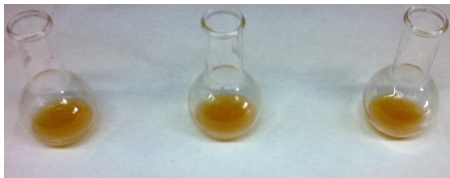
Εικόνα 8. Δείγματα χυμού μανταρινιού μετά τη αντίδραση της 2,6-διχλωροινδοφαινόλης με το ασκορβικό οξύ. Η μετατροπή του χρώματος από πορτοκαλί σε μπλε σηματοδοτεί το τέλος της τιτλοδότησης.
