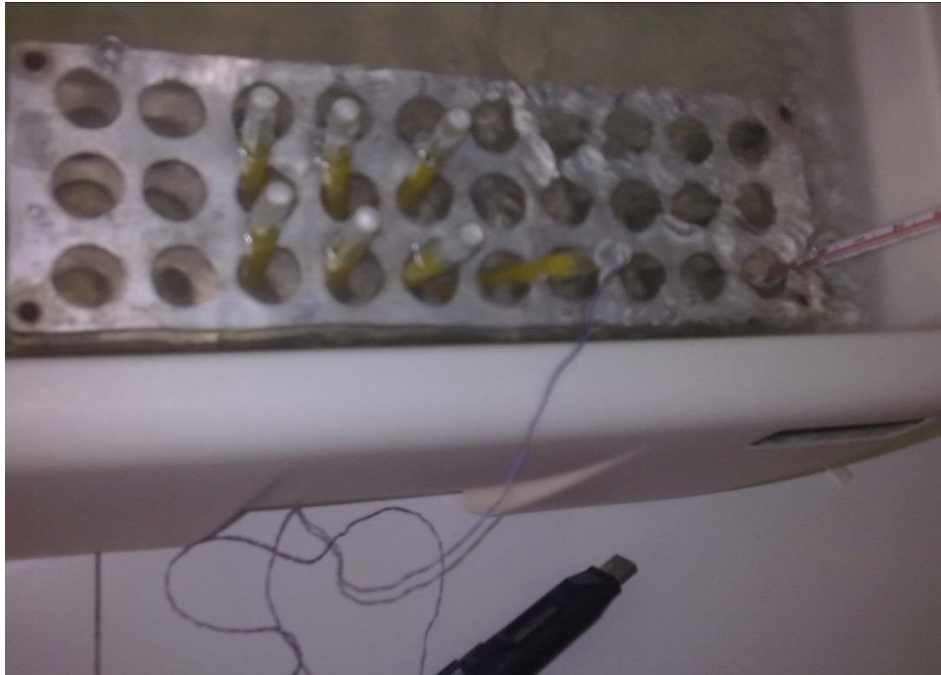
Εικόνα 5. Θέρμανση δειγμάτων χυμού σε υδατόλουτρο.
