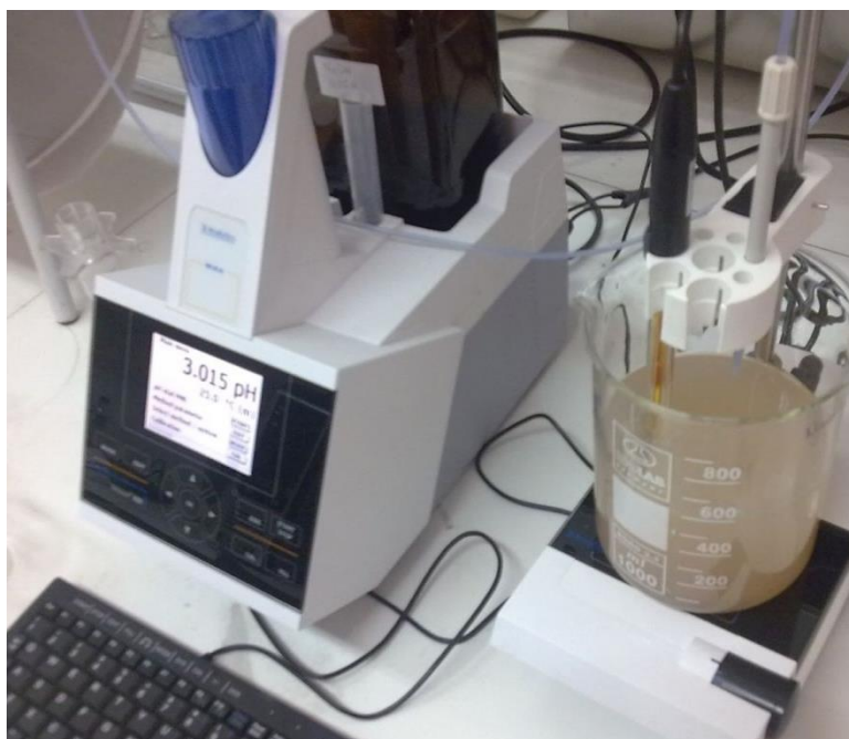
Εικόνα. 6. Μέτρηση και ρύθμιση του pH του ενζυμικού υποστρώματος μέσω του αυτόματου τιτλοδότη.
