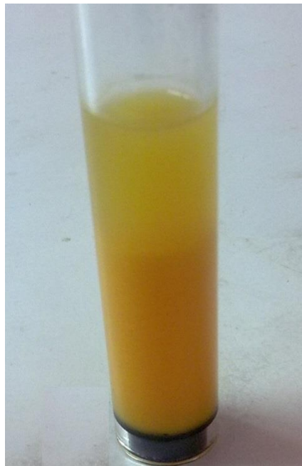
Εικόνα. 3. Αποσταθεροποίηση θολώματος και σχηματισμός φάσεων.
