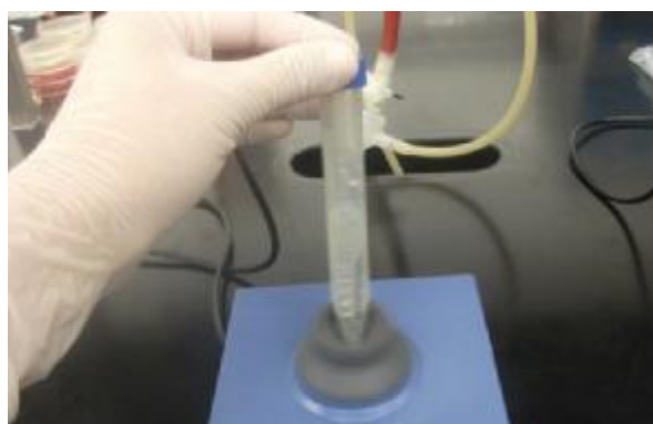
Εικόνα 13. Στροβιλισμός κουπονιού ανοξειδωτού χάλυβα με 10 σφαιρίδια για την αποκόλληση των βιοϋμενικών κυττάρων και τη μεταφορά τους στο υγρό διάλυμα ( ¼ Ringer)
