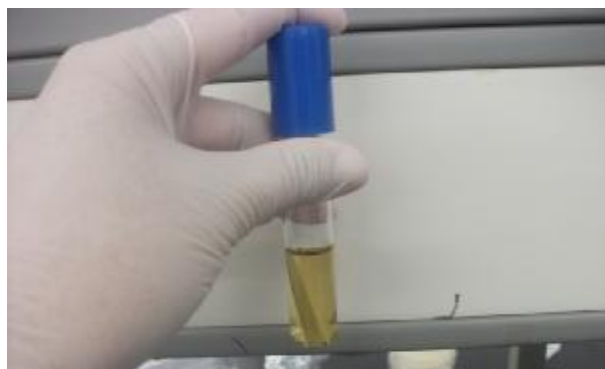
Εικόνα 12. Τοποθέτηση κουπονιού ανοξειδωτού χάλυβα σε θρεπτικό υπόστρωμα Tryptone Soya Broth για την ανάπτυξη του βιοϋμενίου
