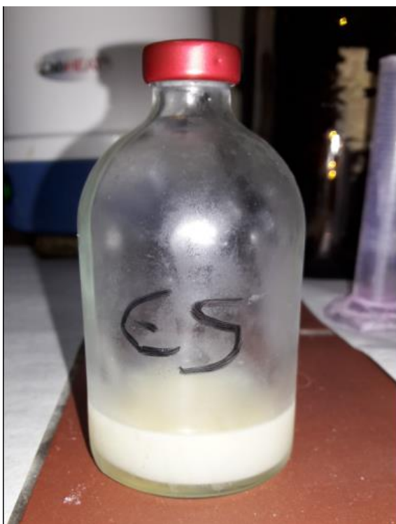
Εικόνα 2.3. 1. Προκαλλιέργεια του στελέχους E5 του είδους C. butyricum σε φιάλη αναεροβίωσης με RCM και γλυκόζη (παρούσα μελέτη)
