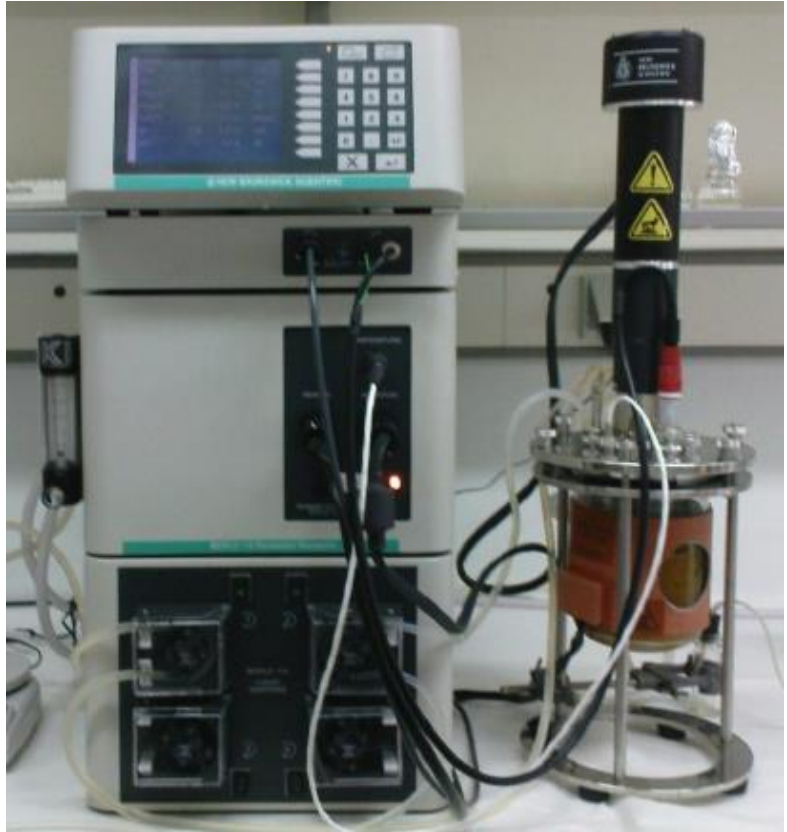
Εικόνα 2.2. 4. Βιοαντιδραστήρας συνολικού όγκου 1.2-L (New Brunswick Scientific, USA) (παρούσα μελέτη)
