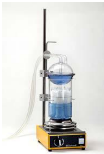
Σχήμα 2.5.2.1: Συσκευή προσδιορισμού κυτταρίνης-λιγνίνης.
