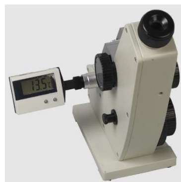
Εικόνα 3.3: Διαθλασίμετρο Kern Optics.
