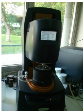
Εικόνα[18]: Γεωμετρία ομόκεντρων κυλίνδρων
