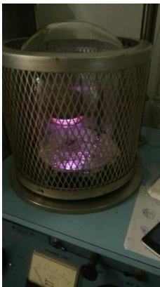
Εικόνα [13] : Διαδικασία επιχρύσωσης δειγμάτων (α), επιχρυσωμένα δείγματα (β)
