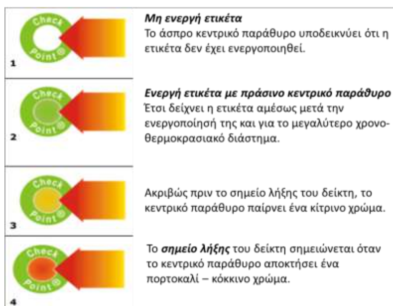
Εικόνα 1.8: Τρόπος λειτουργίας τρίχρωμου ενζυμικού ΤΤΙ της VITSAB.
