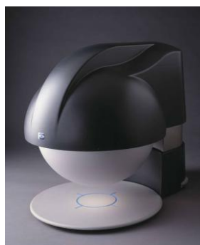
Εικόνα 2.2.2.2.1.: Συσκευή πολυφασματικής ανάλυσης εικόνας VideometerLab.
