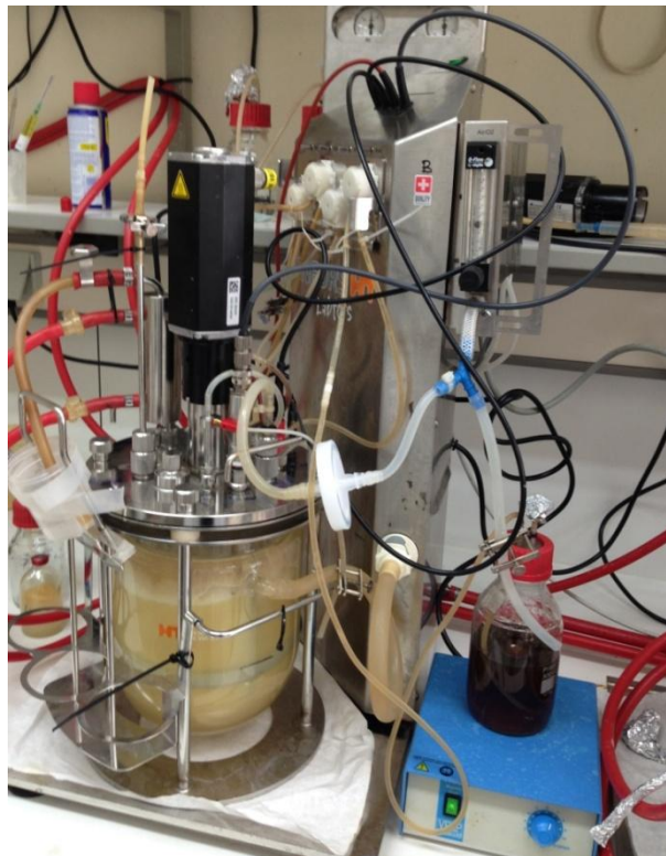
Εικόνα 2 Ημι-συνεχής ζύμωση του Enterobacter sp. σε βιοαντιδραστήρα όγκου 3.7 L με συνεχόμενη τροφοδοσία.
