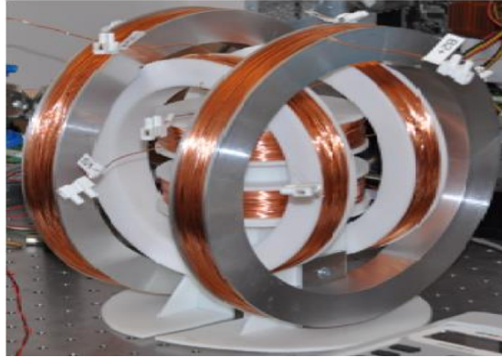
Εικόνα 1.1: Συσκευή με πηνία Helmholtz για in vitro μελέτες (πηγή : http://www.directvacuum.com/ )
