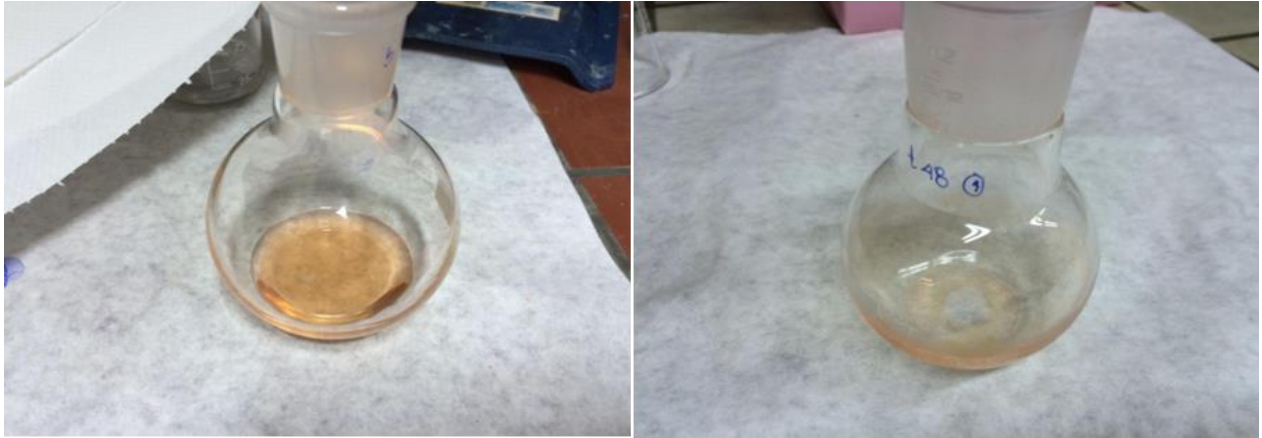
Εικόνα 2.2.7: Φιάλη εξάτμισης πριν (α) και μετά (β) την εξάτμιση όπου α) μίγμα διαλυτών χλωροφόρμιο:μεθανόλη για εκχύλιση του λίπους και β) μικροβιακό έλαιο.
