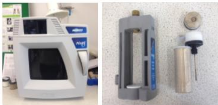
Εικόνα 7: Εξοπλισμός CEM MARS 6 (αριστερά) και δοχείο δείγματος control (δεξιά).
