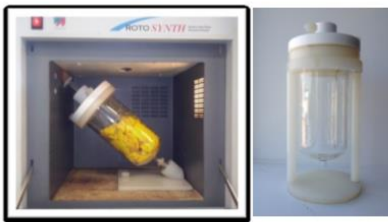
Εικόνα 6: Εξοπλισμός Milestone ROTOSYNTH που περιέχει αλεσμένες φλούδες πορτοκαλιού για εκχύλιση D-λιμονένιου (αριστερά) και σκεύος 2 L Pyrex ® (δεξιά).
