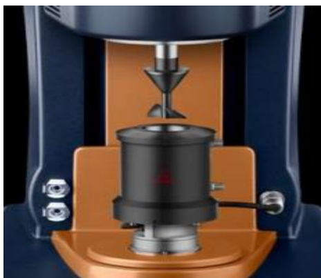
Εικόνα 9: Γεωμετρία μέτρησης θερμορρολογικών ιδιοτήτων – Starch Pasting Cell.
