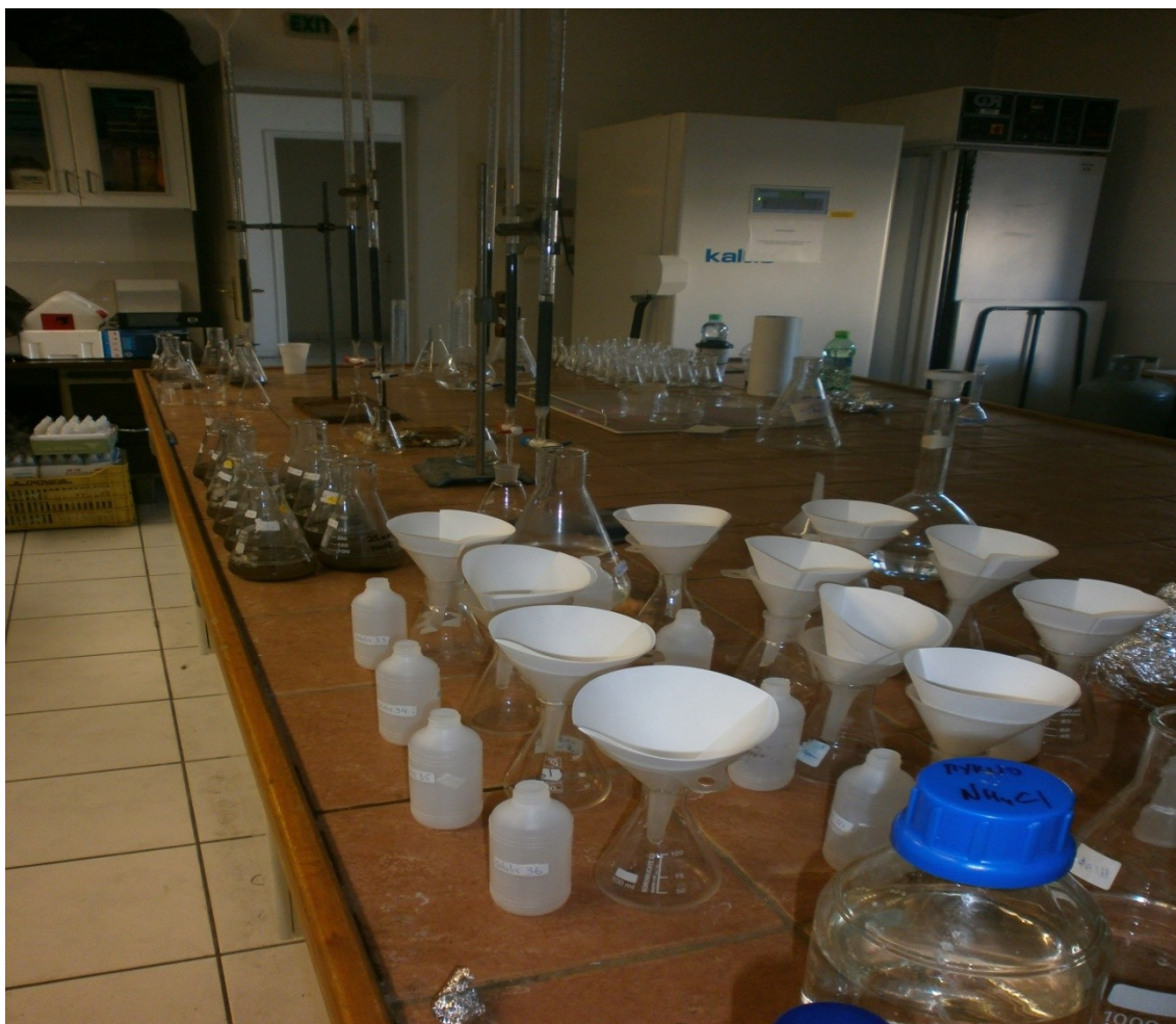
Εικόνα 9. Εκχύλιση δειγμάτων εδάφους και στήλες καδμίου (Cd) για τον προσδιορισμό των συγκεντρώσεων NO 3 - .
