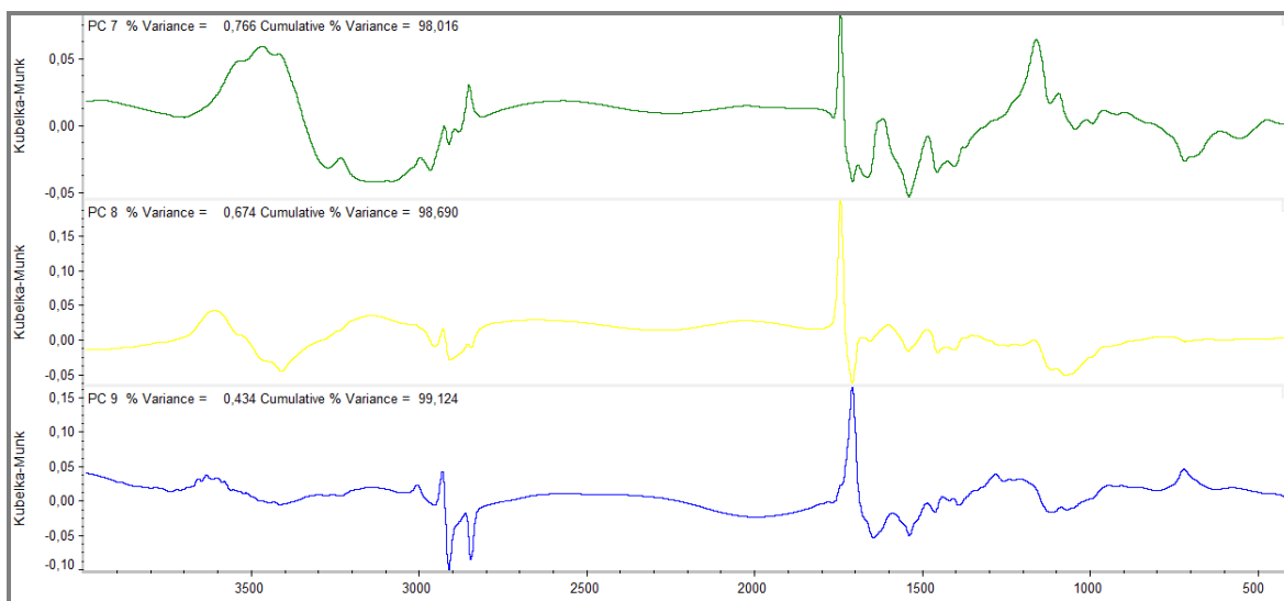
Εικόνα 6.4. Φάσμα FTIR κύριων συνιστωσών 7,8,9 κονιορτοποιημένων δειγμάτων.
