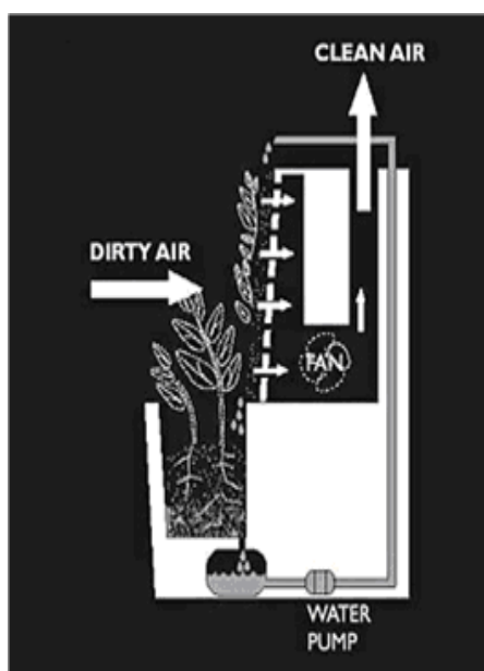
Εικόνα 6: Μηχανισμός φυτικού τοίχους «Βιοφίλτρο», (Δ3)
