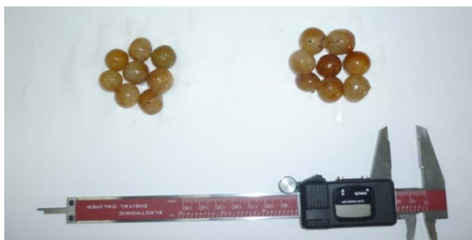
Εικόνα 11. Μέτρηση διαμέτρου με χρήση παχυμετρικού διαβήτη
