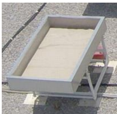
Εικόνα 3.7. Λυσίμετρο χωρίς διατάξεις φυτεμένου δώματος το οποίο χρησίμευσε ως μάρτυρας ενός συμβατικού μη φυτοκαλυμμένου δώματος.
