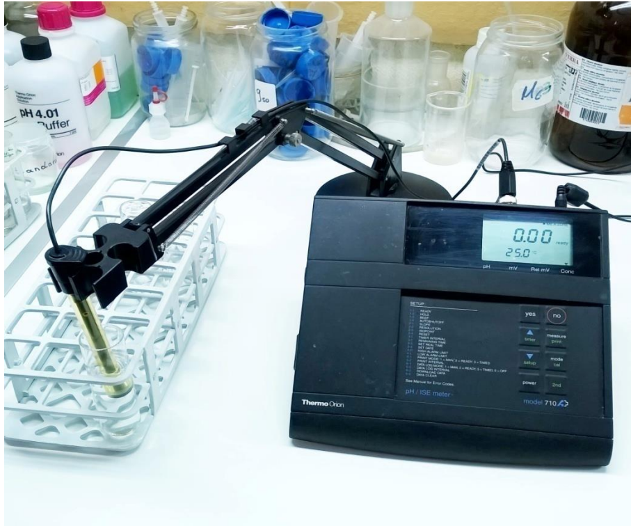
Εικόνα 3.13. Το ηλεκτρόδιο μέτρησης νιτρικών ThermoOrion 9700 BNWP συνδεδεμένο με τον ψηφιακό καταγραφέα της ThermoOrion model 710.
