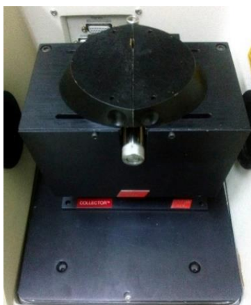
Εικόνα 15. Εξάρτημα με υποδοχέα δείγματος για τη λήψη φασμάτων υπέρυθρου με την τεχνική DRIFTS.
