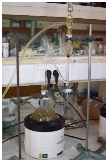
Εικόνα 10. Το σύστημα της απόσταξης (από κάτω προς τα πάνω) με το θερμομανδύα, τη συσκευή Clevenger και το συμπυκνωτή συνδεδεμένο με το νερό της βρύσης.
