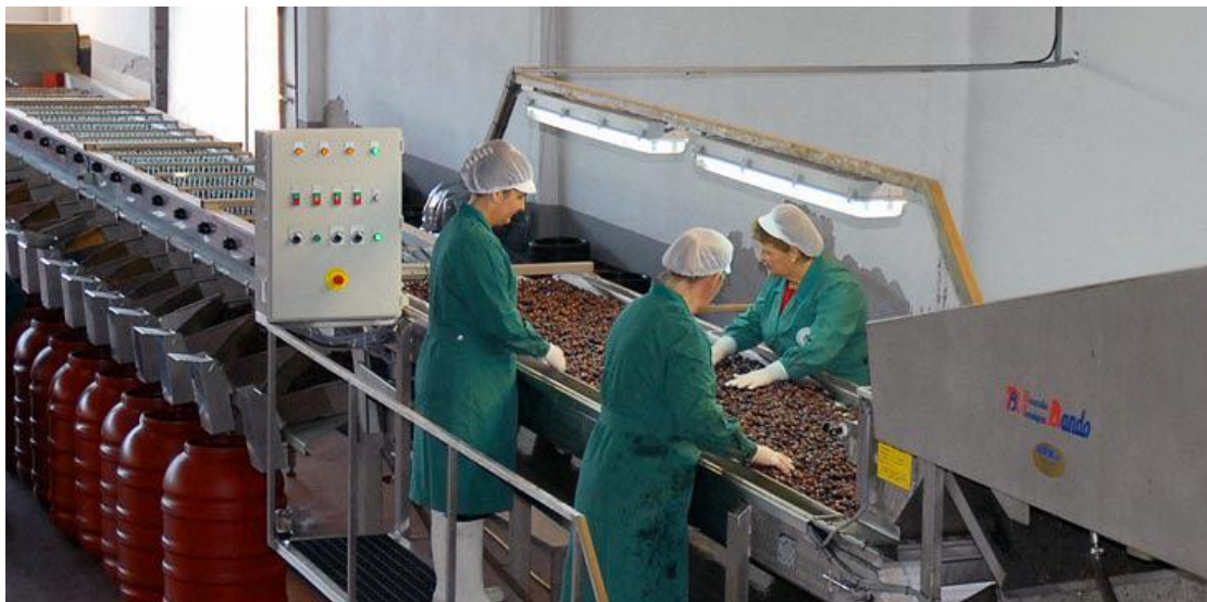
Εικόνα 9. Πλυντήριο με ενσωματωμένη ταινία διαλογής(εντοιχισμένο με υπερυψωμένο βάθρο εργασίας) και διαλογή μεγέθους
