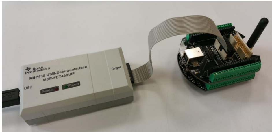
Εικόνα 7.19. Παράδειγμα προγραμματισμού και εκοφαλμάτωσης μικροελεγκτή πλακέτας επέκτασης (WNL_DASH7) μέσω πλακέτας επέκτασης προγραμματισμού και εκοφαλμάτωσης (PDL_USB_JTAG).
