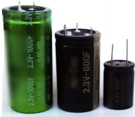
Εικόνα 8.1. Οι τρεις υβριδικοί υπερποκνωτές που επελέγησαν για δοκιμές (1000 F ο πράσινος, 800 F ο μαύρος, και 200 F ο καφέ).
