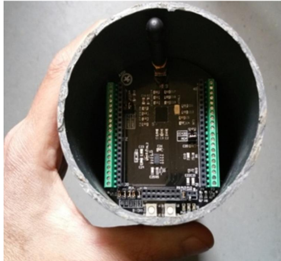
Εικόνα 5.5. Φωτογραφία πλακέτας επέκτασης κόμβου ασύρματου δικτύου αισθητήρων τοποθετημένης εντός περιβλήματος στέγασης από πλαστικό σωλήνα.
