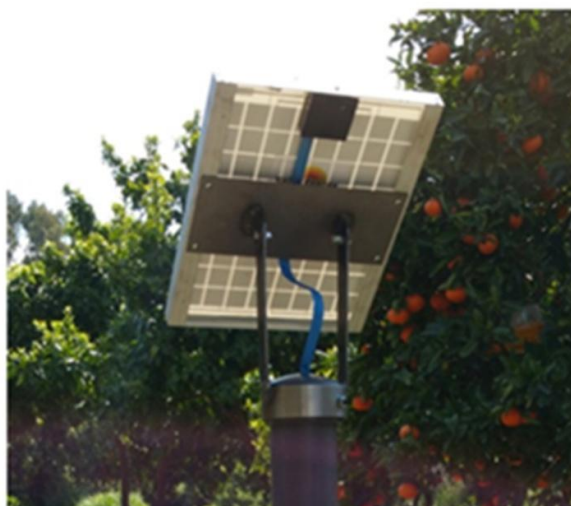
Εικόνα 5.7. Λεπτομέρεια από κόμβο αρχιτεκτονικής SensoTube στην οποία διακρίνεται ο μηχανισμός στήριξης της φωτοβολταϊκής κυψέλης στο άνω άκρο του φορέα στήριξης.
