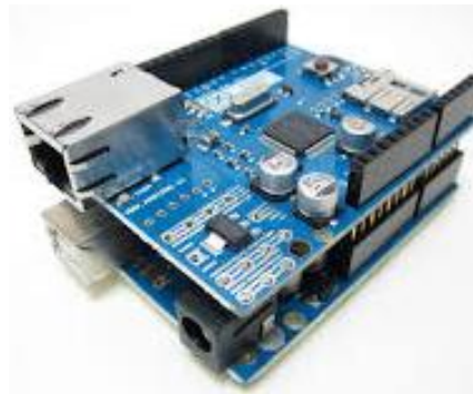
Εικόνα 2.5. Χαρακτηριστικό παράδειγμα σύνθεσης συστήματος αρχιτεκτονικής υλικού ανοικτής πηγής χρησιμοποιώντας μια κύρια πλακέτα επέκτασης ( Arduino Uno Rev.3 στην συγκεκριμένη περίπτωση) και μια πλακέτα επέκτασης. Οι δύο πλακέτες συνδέονται μεταξύ τους μέσω των συνδετήρων επέκτασης. Στο επάνω μέρος του συστήματος μπορούν να συνδεθούν αρκετές ακόμα πλακέτες επέκτασης.
