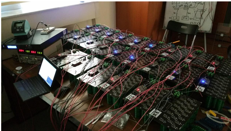
Εικόνα 8.24. Διασυνδεδεμένες συσκευές μέτρησης και ελέγχου στοιχείων υβριδικών υπερπυκνωτών κατά τη διαδικασία δοκιμών για τη δημιουργία ενιαίας αποθήκης ενέργειας.
