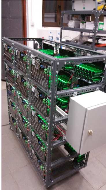
Εικόνα 8.25. Ερμάριο αποθήκευσης ενέργειας βασισμένης σε διασυνδεδεμένες ελεγχόμενες συστοιχίες υβριδικών υπερπυκνωτών.
