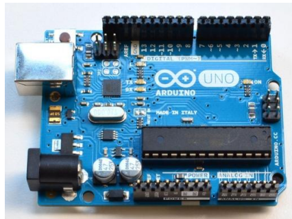
Εικόνα 2.4. Η κύρια πλακέτα επέκτασης αρχιτεκτονικής υλικού ανοικτής πηγής Arduino Uno Rev.3 (της εταιρίας Arduino ). Διακρίνονται δύο σειρές με συνδετήρες για την σύνδεση πλακετών επέκτασης.
