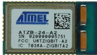
Εικόνα 2.24. Το ολοκληρωμένο λειτουργικό υποσύστημα ZigBit ATZB-24A2 (της εταιρίας Atmel) για την ασύρματη δικτύωση και επικοινωνία βάσει του πρωτοκόλλου IEEE 802.15.4/ZigBee στα 2.4 GHz. Οι φυσικές διαστάσεις του είναι 18.8 x 13.5 mm και περιέχει chip antenna.
