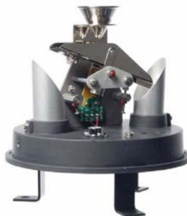
Εικόνα 5. Λεπτομέρειες κατασκευής βροχόμετρου με tipping bucket (Αριστερά: http://novalynx.com και Δεξιά: http://www.allweatherinc.com )
