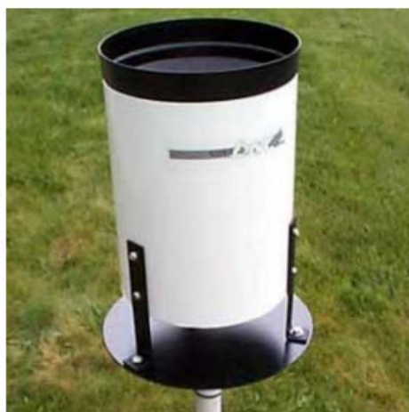
Εικόνα 5. Λεπτομέρειες κατασκευής βροχόμετρου με tipping bucket (Αριστερά: http://novalynx.com και Δεξιά: http://www.allweatherinc.com )
