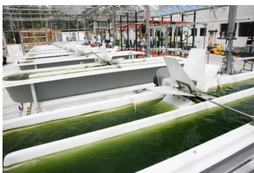
Εικόνα 1. 13: Ανοιχτό σύστημα καλλιέργειας μικροφυκών. Πηγή εικόνας: http://fashions-cloud.com/pages/a/algae-biofuel-open-pond/ .
