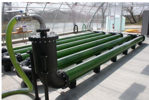
Εικόνα 1. 12: Φωτο-βιοαντιδραστήρες για παραγωγή βιομάζας μικροφυκών. Πηγή εικόνας: http://www.climatetechwiki.org/ .
