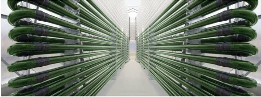
Εικόνα 1. 14: Σωληνοειδείς βιοαντιδραστήρες παραγωγής βιομάζας μικροφυκών. Πηγή εικόνας: http://www.algaeindustrymagazine.com/ .
