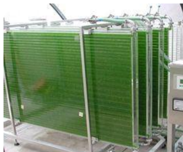
Εικόνα 1. 15: Βιοαντιδραστήρες με επίπεδες πλάκες παραγωγής βιομάζας μικροφυκών. Πηγή εικόνας: http://www.chempuretech.com/renewable-energy-algae-photo-bioreactors.html .
