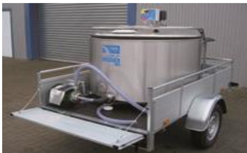
Εικόνα 12: Τρέιλερ με ειδική παγολεκάνη για την μεταφορά του γάλακτος
