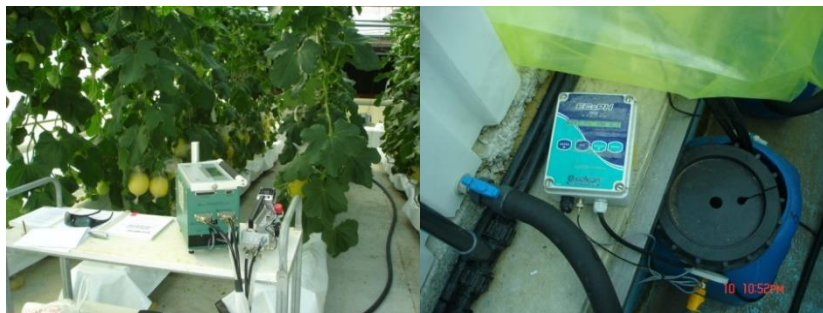
Εικόνα 3.5. Συσκευή μέτρησης φωτοσυνθετικών παραμέτρων (LI-COR 6400) των φυτών και όργανο μέτρησης της EC και του pH του θρεπτικού διαλύματος.
