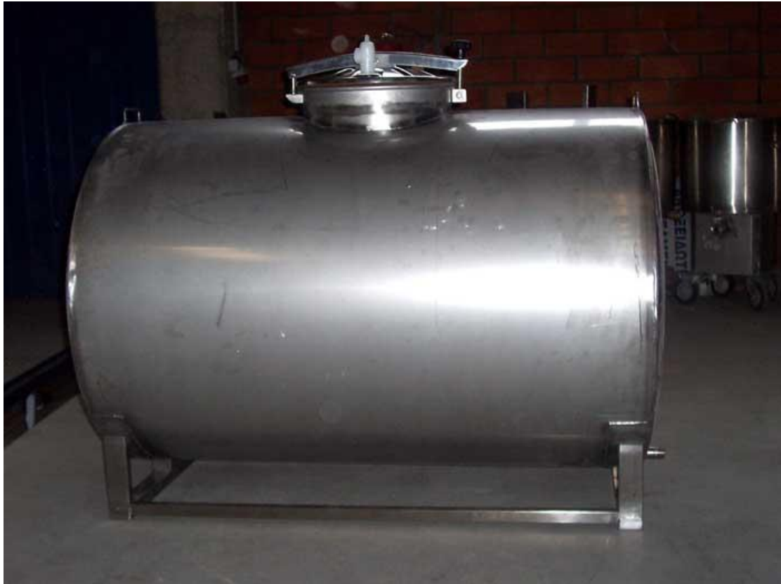
Εικόνα 9 Δεξαμενή λαδιού inox χωρητικότητας 1 τόνου)
