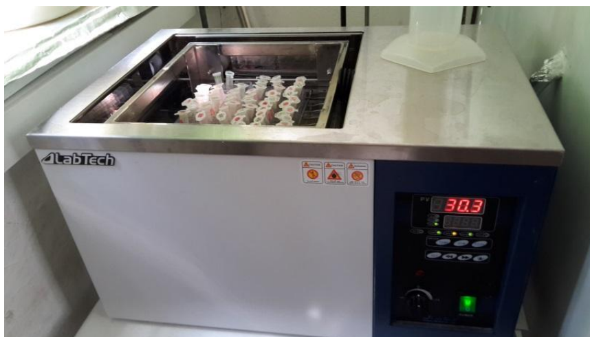
Εικ. 7: Υδατόλουτρο Daihan Labtech co Ltd στο οποίο τοποθετήθηκαν τα πλαστικά φυαλίδια (Eppendorf tubes), που περιείχαν τα δείγματα.
