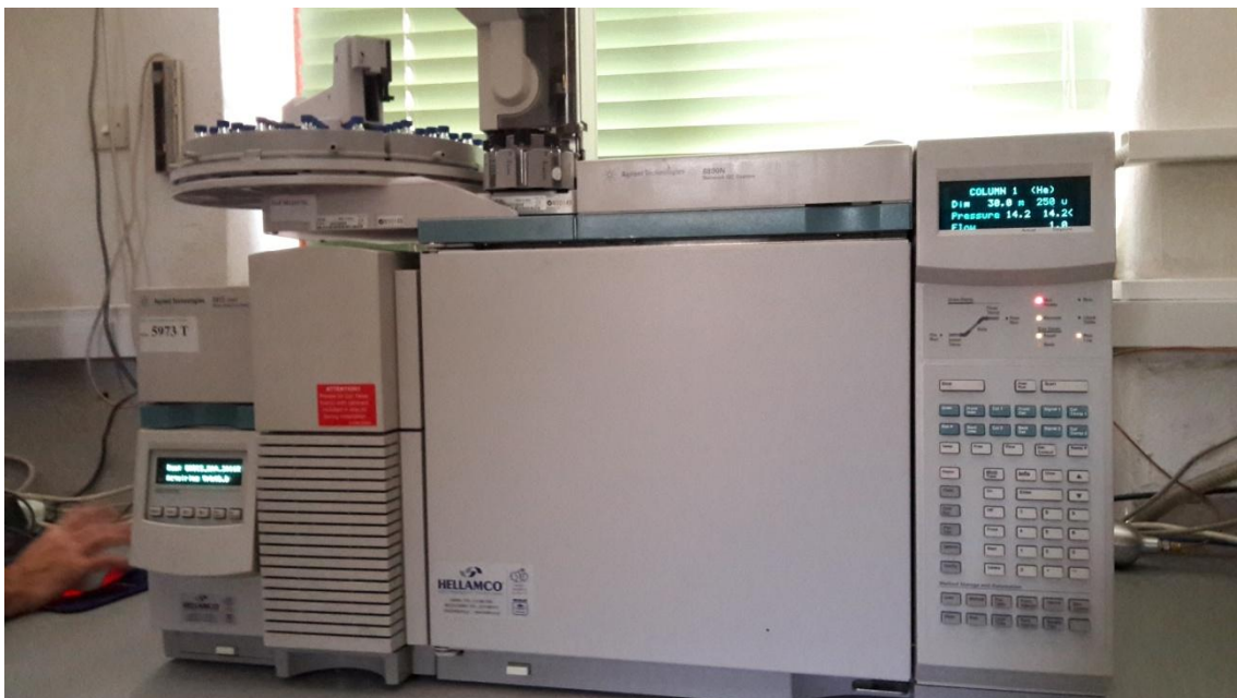
Εικ. 9: Για τις αναλύσεις χρησιμοποιήθηκε GC/EI/MS Agilent με αυτόματο δειγματολήπτη, στήλη HP-5MS και φέρον αέριο ήλιο.
