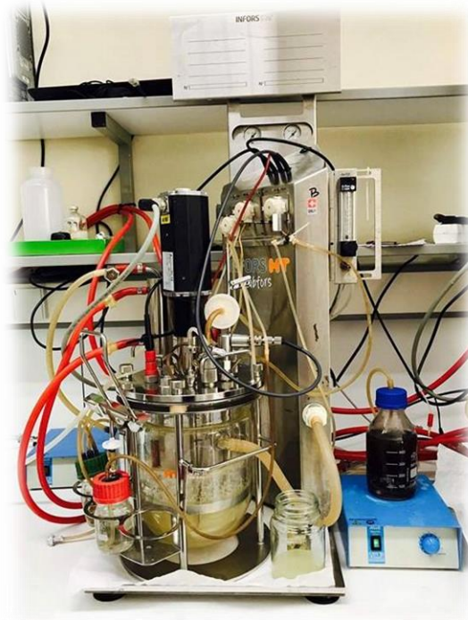
Εικόνα 4: Ημι-συνεχής ζύμωση του μικροοργανισμού Enterobacter ludwigii σε βιοαντιδραστήρα όγκου 3.7 L.
