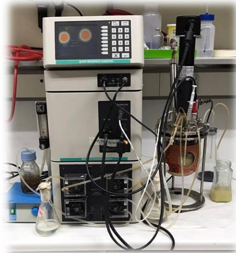
Εικόνα 5: Ημι-συνεχής ζύμωση του μικροοργανισμού Enterobacter ludwigii σε βιοαντιδραστήρα όγκου 1 L.
