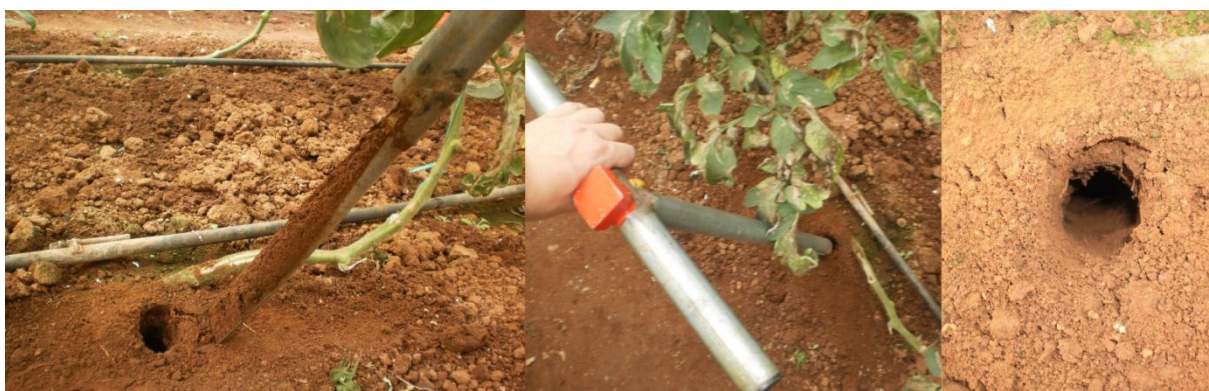
Εικόνα 3.4 Ο δειγματολήπτης εδάφους που χρησιμοποιήθηκε. Η συλλογή εδάφους έγινε σε βάθος 0-40 cm και 2-4 cm απόσταση από το λαιμό του φυτού.
