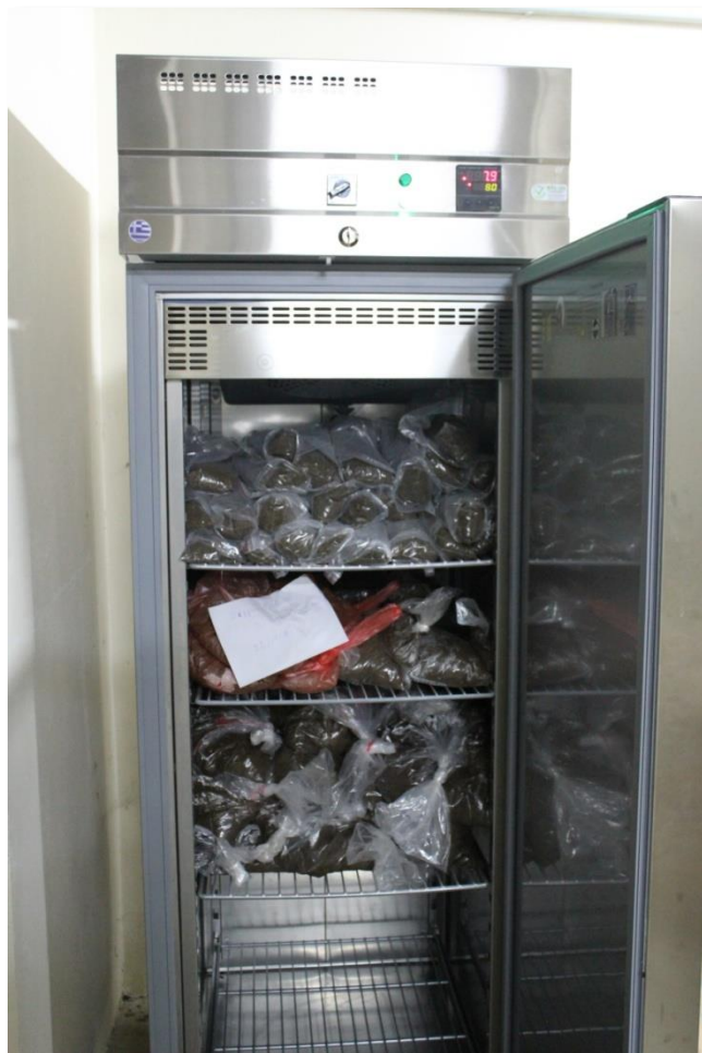
Εικόνα 3.5 Θάλαμος ελεγχόμενων συνθηκών, ο οποίος χρησιμοποιήθηκε για την αποθήκευση των δειγμάτων εδάφους. Η θερμοκρασία ρυθμίστηκε στους 8 °C.
