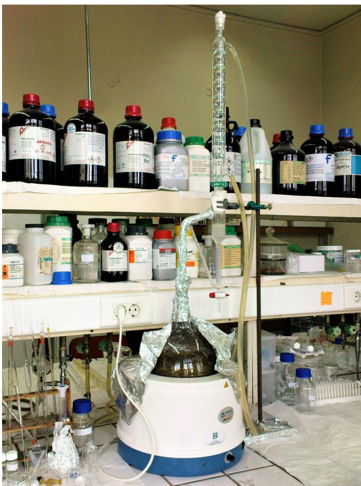
Εικόνα 2.6 Συσκευή απόσταξης Clevenger.
