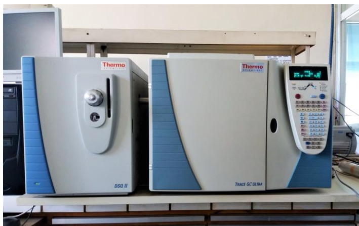
Εικόνα 2.7 Σύστημα αέριας χρωματογραφίας-φασματομετρίας μαζών (GC-MS).
