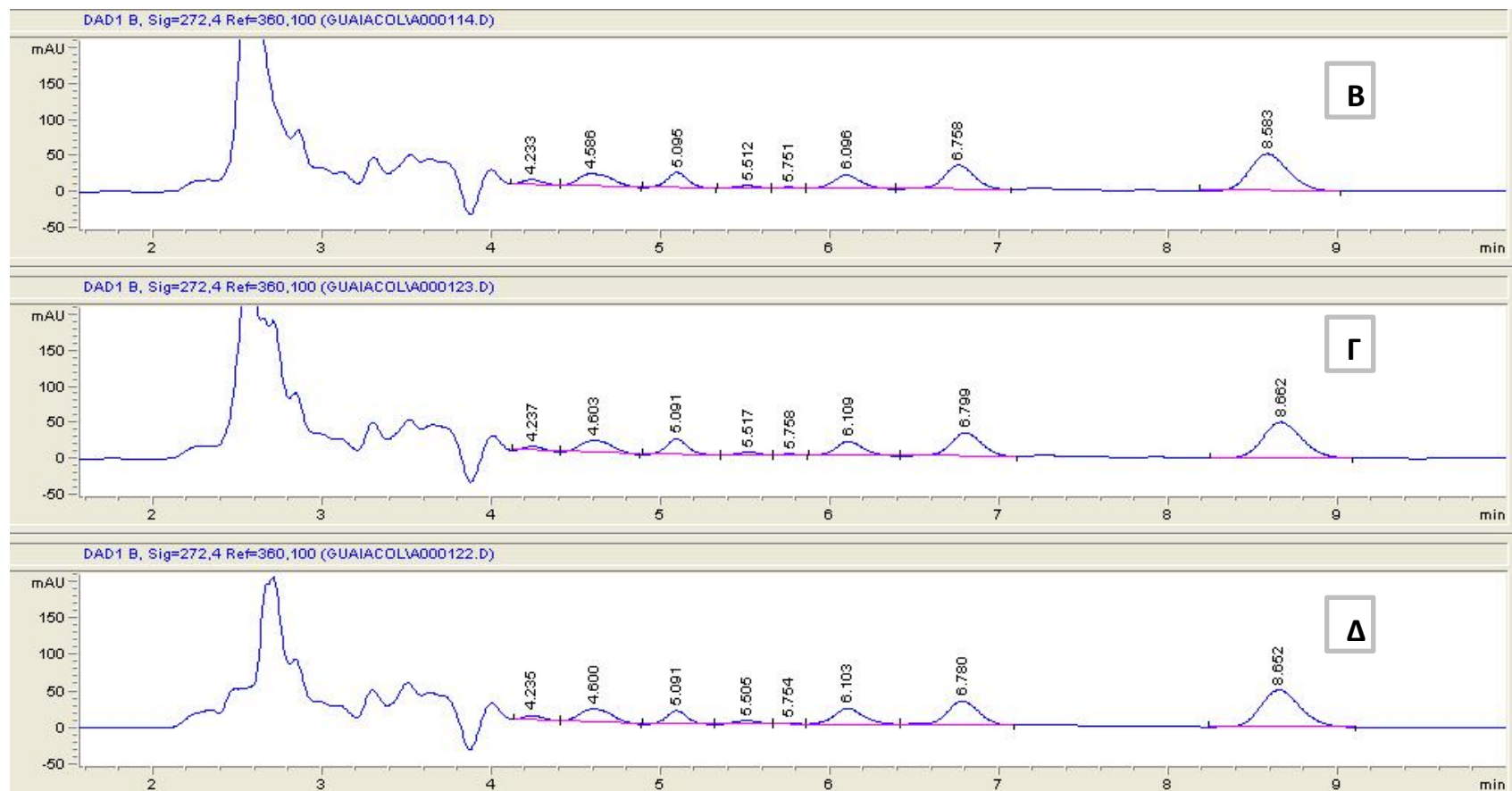
Γράφημα 3.8. Χρωματογραφήματα που λήφθηκαν κατά την ανάλυση δειγμάτων χυμού που είχαν επωαστεί στους 25°C. Το χρωματογράφημα Β αντιστοιχεί στην στιγμή εμβολιασμού, το Γ στην 4 η μέρα επώασης και το Δ στην 9 η μέρα επώασης.
