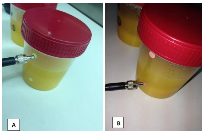
Εικόνα 2.2. Τοποθέτηση του αισθητήρα για μέτρηση του διοξειδίου του άνθρακα στο αυτοκόλλητο (κίτρινο) που βρίσκεται επιφανειακά του χυμού (A), και τοποθέτηση του αισθητήρα για μέτρηση του οξυγόνου στο αυτοκόλλητο (ροζ) εσωτερικά του χυμού (B).
