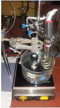
Εικόνα 11: Μαγνητικός αναδευτήρας με κρυο-vial SPME
