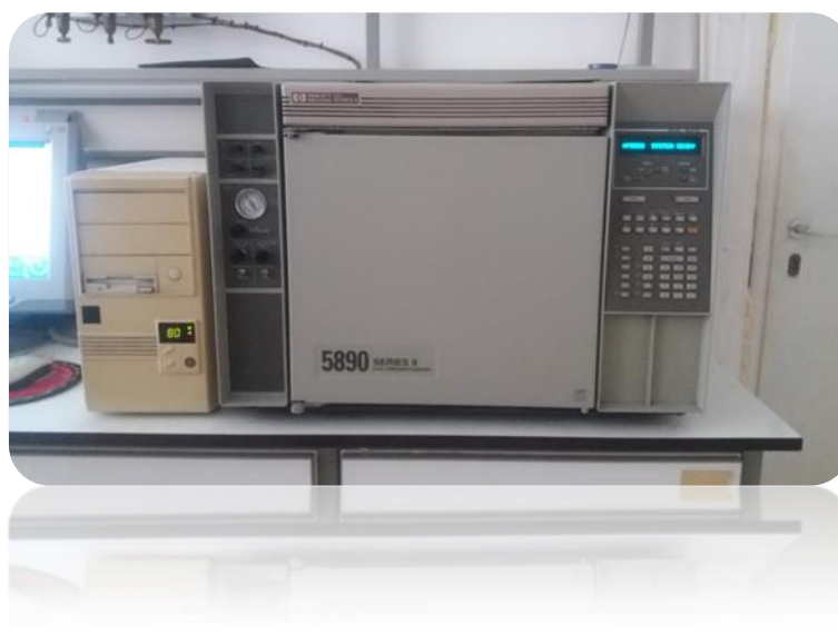
Εικόνα 10: GC-FID (Gas-Chromatography-Flame Ionization Detector)
