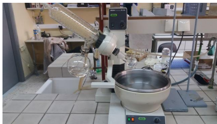
Εικόνα 9: Περιστροφικός εξατμιστήρας Rotavapor R-114
