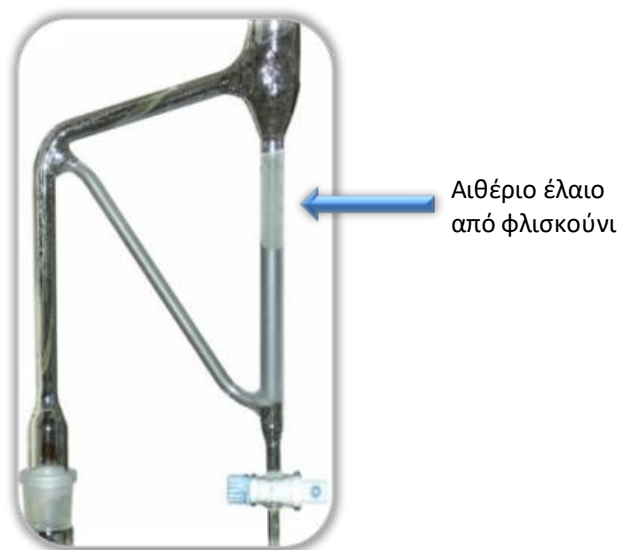
Εικόνα 2.4. Συσκευή τύπου Clevenger για την παραλαβή αιθερίου ελαίου από φλίσκουνι με υδροαπόσταξη (HD).
