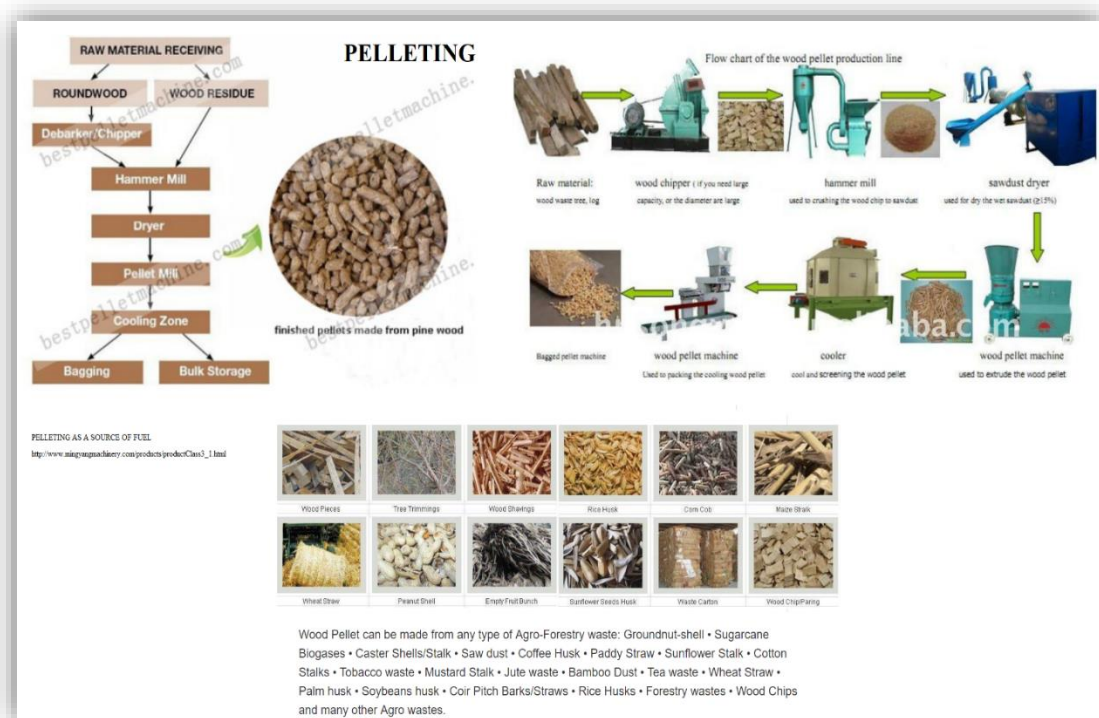
Εικόνα 76. Διάγραμμα ροής της πελετοποιητικής διαδικασίας. Πηγή: www.mingyangmachinery.com/products/productClass3_1.html (Gongyi Xiaoui Mingyang Machinery plant).
