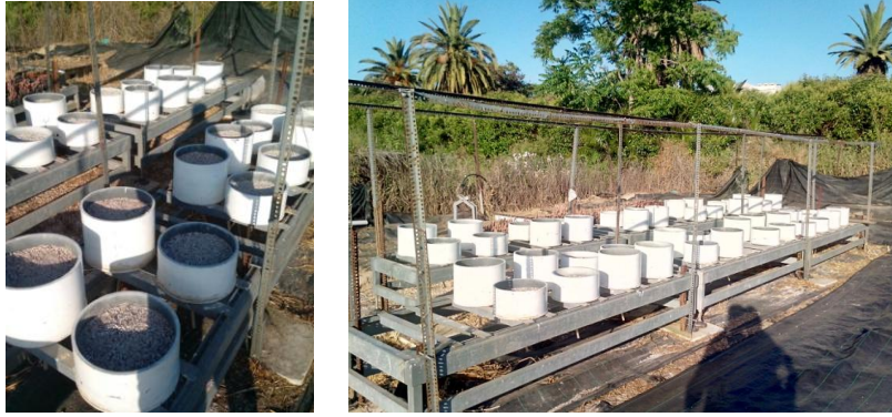
Εικόνες 23, 24. Τα πειραματικά λυσίμετρα της μελέτης, πριν την τοποθέτηση του χλοοτάπητα.
