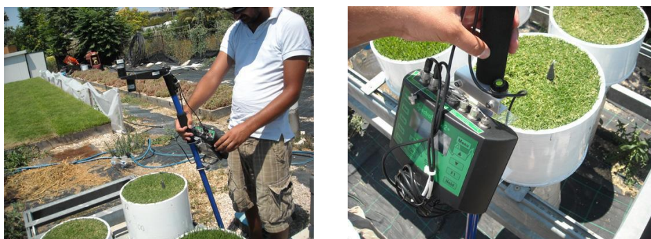
Εικόνες 29, 30. Μετρήσεις NDVI με τη χρήση δύο διπλοκάναλων αισθητήρων SKR 1800
