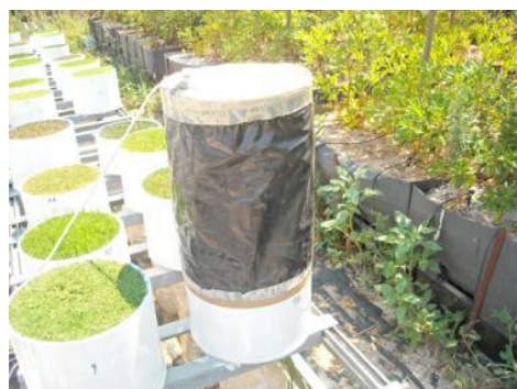
Εικόνα 27: Μετακινούμενος κυλινδρικός φωτογραφικός θάλαμος
