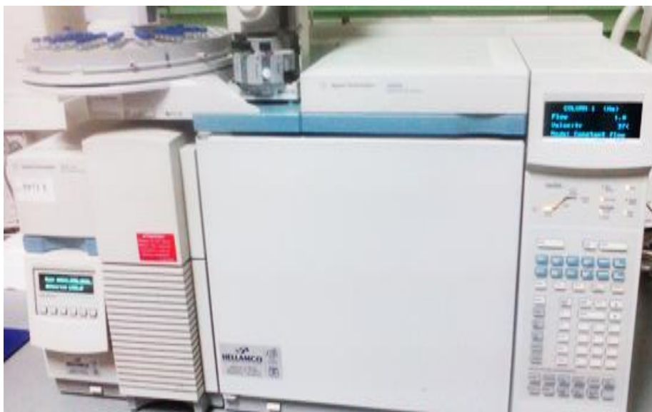
Εικόνα 23. Αέριος χρωματογράφος Agilent 6890N με ανιχνευτή μάζας MS 5973 inert mass selective detector (MSD).
