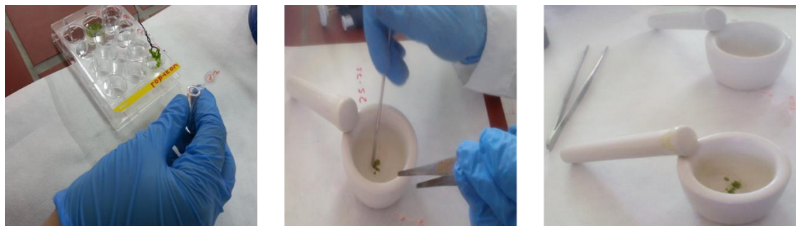
Εικόνα 22. Συλλογή φυτών L. minor L. σε erpendorfs και λειοτριβίση σε γουδιά με υγρό άζωτο.
