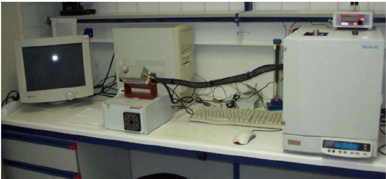
Εικόνα 3.7.: Σύστημα αέριου χρωματογράφου εργαστηρίου οινολογίας ΓΠΑ
