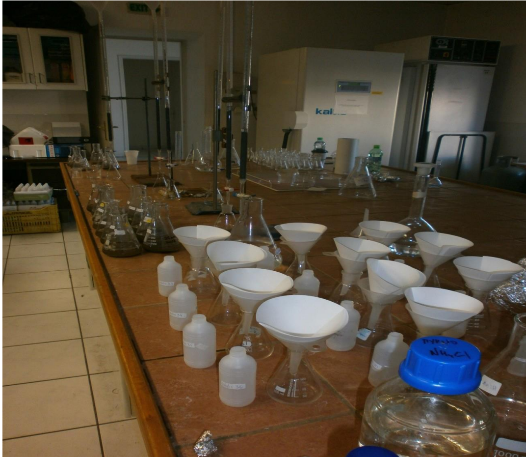
Εικόνα 18. Εκχύλιση δειγμάτων εδάφους και στήλες καδμίου ( \text{Cd} ) για τον προσδιορισμό των συγκεντρώσεων \text{NO}_3^-
