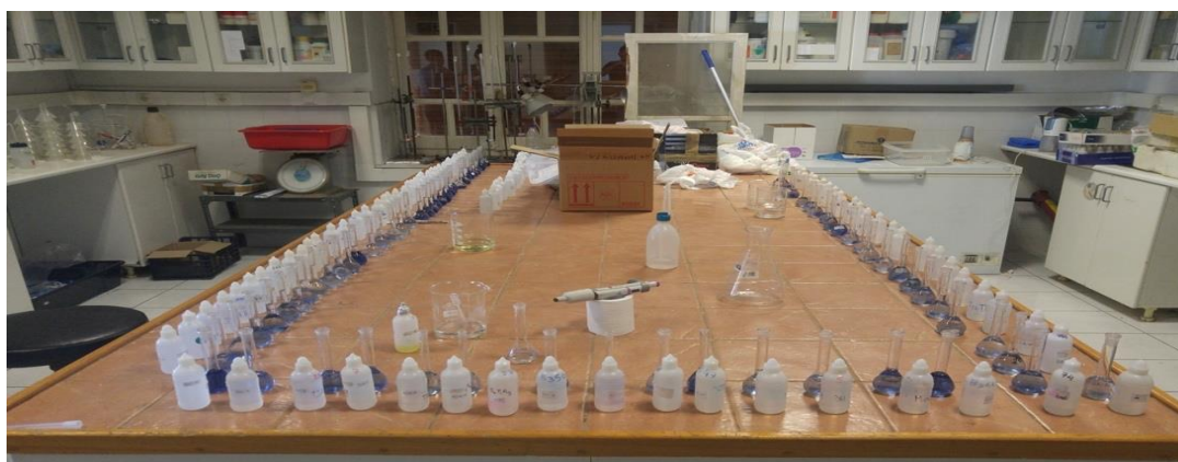
Εικόνα 2.9. Προσδιορισμός Φωσφόρου (P) με τη μέθοδο Murphyr-Riley
