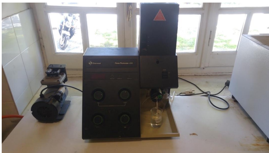
Εικόνα 2.8. Φλογοφωτόμετρο (Sherwood Model 410, Cambridge, UK)
