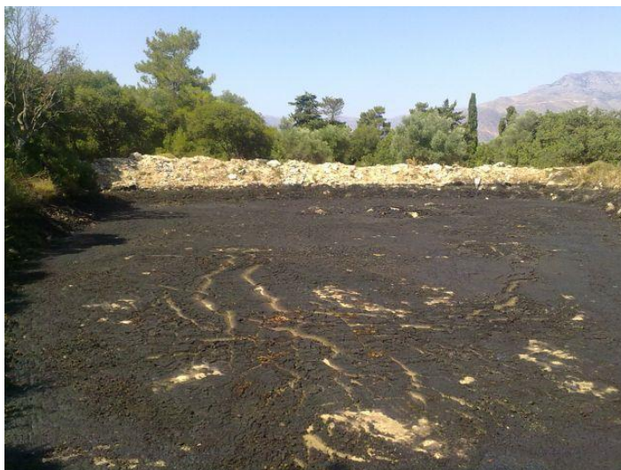
Εικόνα1.7: Το ίζημα που απομένει μετά την εξάτμιση του υγρού αποβλήτου
