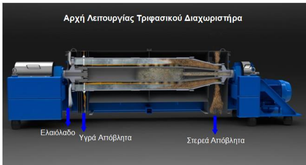
Εικόνα1.3: Ο τρόπος διαχωρισμού της ελαιόπαστας σε τρία κλάσματα
