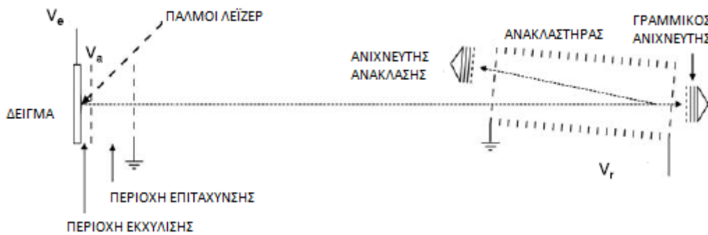
Σχήμα Α.30. Σχήμα ενός φασματογράφου MALDI-TOF με ανακλαστήρα 152
